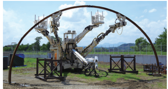
鋼製支保工建込みロボット全景
