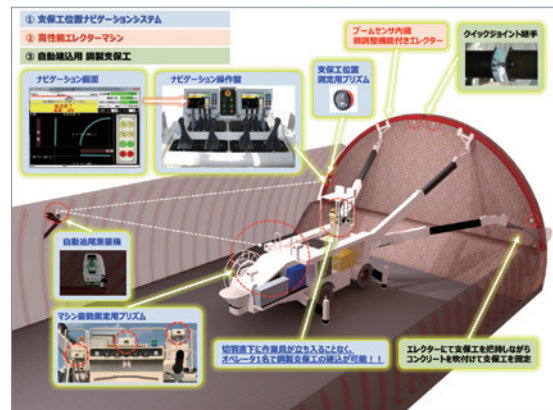
鋼製支保工建込みロボット概念図
